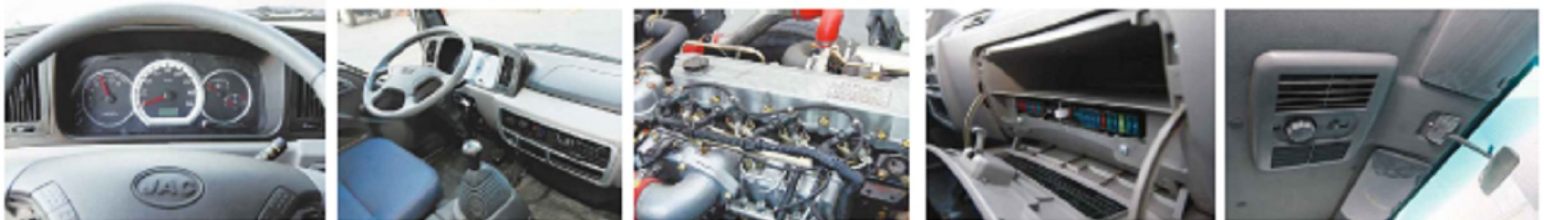
El cuadro de instrumentos, con lecturas simples, claras y precisas (izquierda); la cabina presenta un diseño atractivo y colores claros; el motor, con licencia Man, eroga 154 hp y 450 Nm de torque (centro). La guantera, aunque también aloja los fusibles, cuenta con espacio para guardar elementos. En el techo del habitáculo, un práctico sistema de ventilación.
