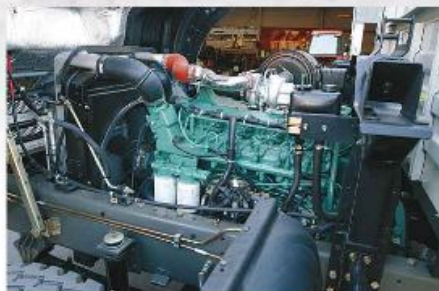
El impulsor FAW de seis cilindros en línea y 6.740 cc, con inyección common rail, entrega hasta 180 hp y 680 Nm de par motor.
